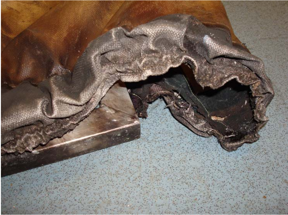
Detailaufnahme vom Rauchverschluss
