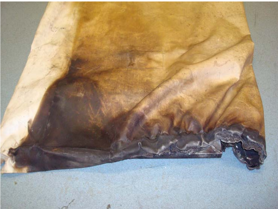
Detailaufnahme vom Rauchverschluss
